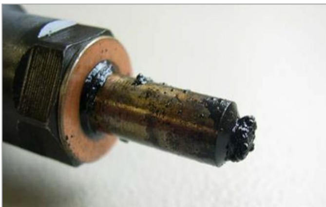
Roetafzetting op een injector na 440 draaiuren met standaard EN590 diesel.
